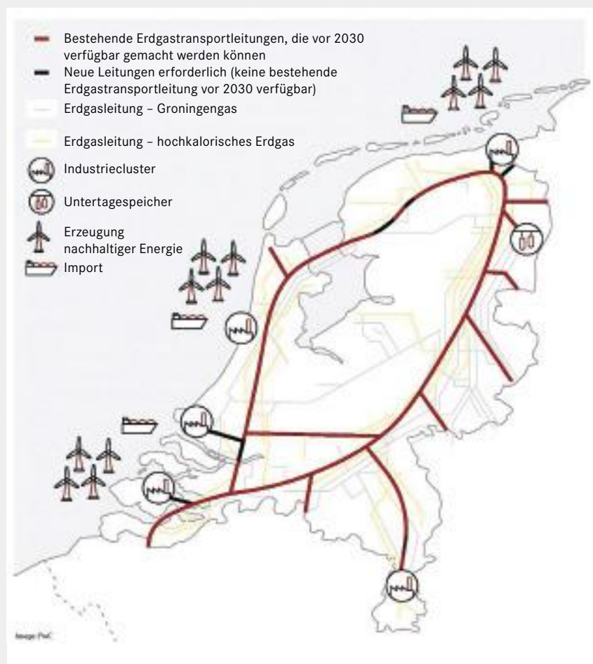
Fig. 1 Die möglichen Wasserstofftransportnetze in den Niederlanden im Jahr 2030: Über einen Transportleitungsring werden niederländische und ausländische Industriecluster sowie Wasserstoffproduzenten und Speicherbetreiber in einem Netzwerk miteinander verbunden. Um alle vorgesehenen Verbraucher an das Transportnetz anschliessen zu können, müssen einige neue Trassen angelegt werden (in der Karte schwarz eingezeichnet). (Quelle: [2])
