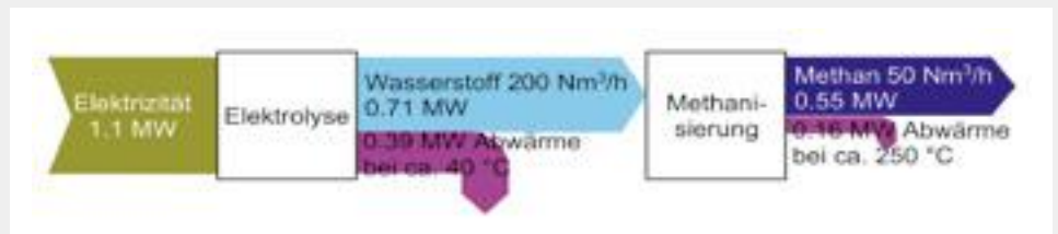
Fig. 4 Energieflussdiagramm von Power-to-Methane im grossen Massstab mit konventioneller Elektrolyse. Elektr. Leistung für Methanisierung und Balance of Plant berücksichtigt. Die Angaben zu den chemische Energieflüssen beziehen sich auf Brennwerte, Wärmeflüsse referenziert auf 25 °C. Farbcodierung s. Fig. 3.
