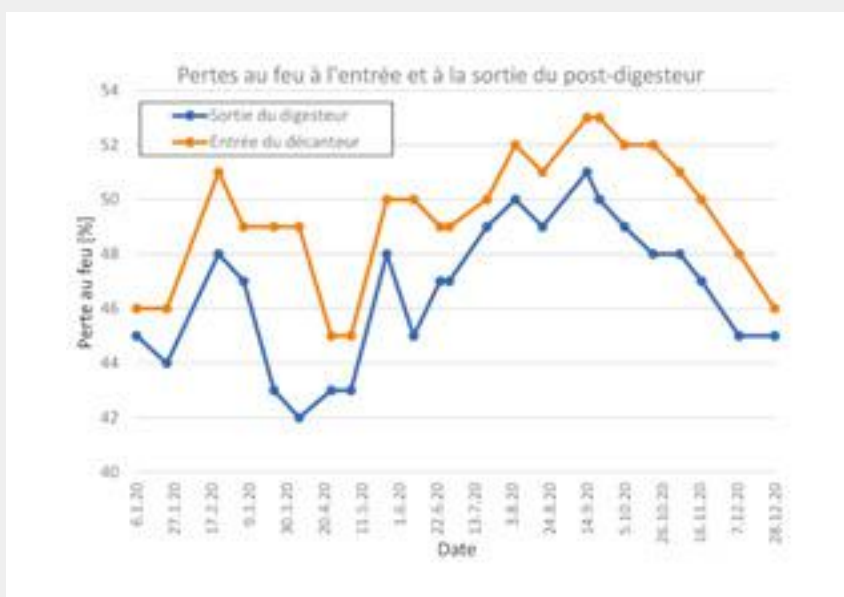
Fig. 2 Modification de la teneur en matière organique dans le stockeur en fonction du temps. Représenté en pourcentage de pertes au feu à l'entrée et à la sortie du post-digesteur.
