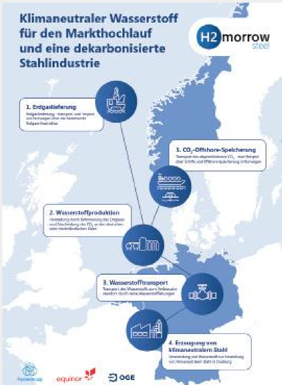
Fig. 2 Schematischer Überblick über die in der Machbarkeitsstudie von H2morrow steel betrachteten Elemente der Herstellung und Verteilung von blauem Wasserstoff. Mittlerweile ist auch der Fernleitungsbetreiber Thyssengas dem Projekt H2morrow steel beigetreten. (Quelle: [4])
