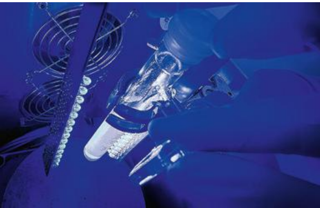
Ulmer Forschende haben die sonnenlichtgetriebene Herstellung von Wasserstoff vom Tagesverlauf entkoppelt. Ihr Einzelmolekülkatalysator kann solaren Wasserstoff auch an dunklen Wintertagen herstellen. Im Bild: Bestrahlungsapparatur im Institut für Anorganische Chemie I.
