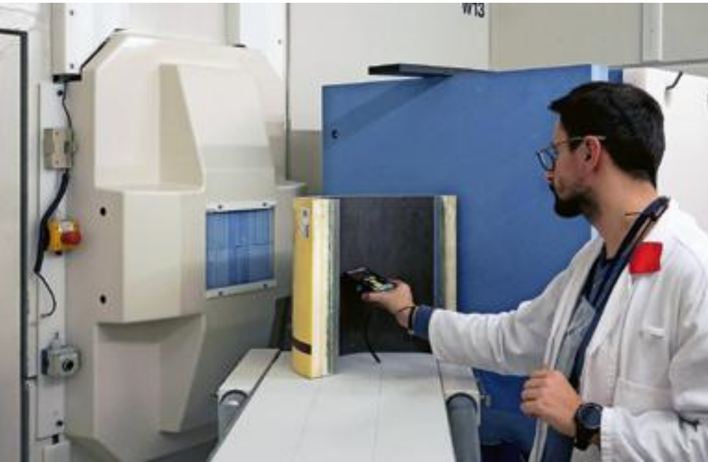
Eine neue neutronenbasierte Methode hilft, Unterwasserpipelines offen zu halten, indem sie die Bildung von Pfropfen in-situ und zerstörungsfrei zu identifizieren vermag. Im Bild: Einrichten eines Pipeline-Rohr-segments am Instrument FaNGAS.
